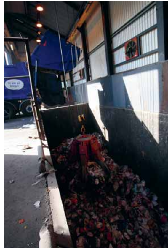
Det brännbara hushållsavfallet i soppåsen komprimeras och transporteras till Uppsala och Högdalenverket i Stockholm, för att omvandlas till el och fjärrvärme.
