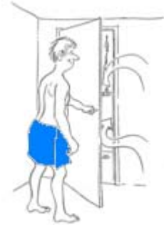
Glänta på badrumsdörren efter duschen
